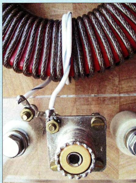
Bild 5: Hauptspule mit direkt an der SO239-Buchse angeschlossener Linkspule
