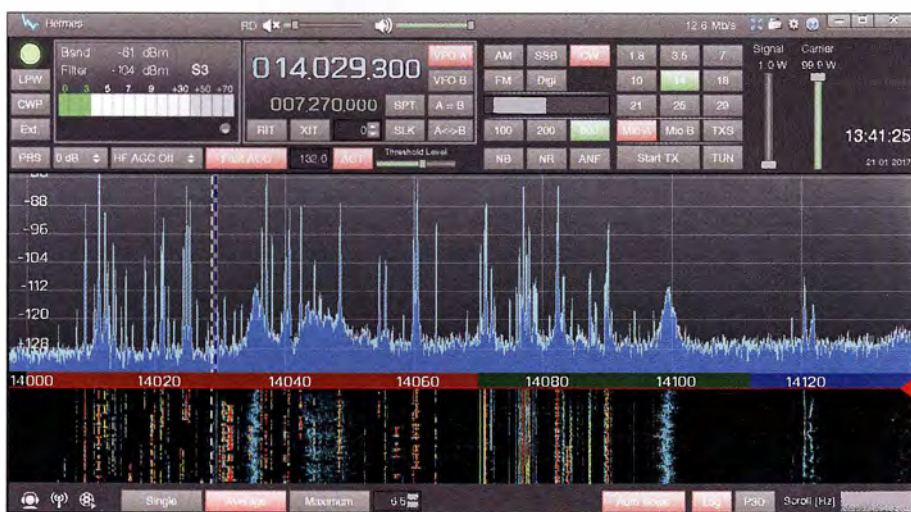
Bild 1: Der Standardbildschirm von Zeus Radio wirkt aufgeräumt und übersichtlich; oben befindet sich das Bedienfeld, in der Mitte die Spektrums- und unten die Wasserfalldarstellung.
