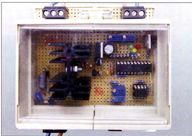
Bild 1: Solarladeregler auf der im Hutschienegehäuse realisierten Lochrasterplatine
