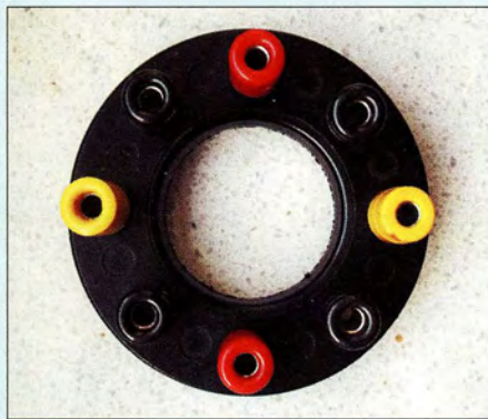
Bild 7: Kunststoffring mit Bananenbuchsen zum Abgriff ausgewählter Windungen der Abstimmspule mit einem Bananenstecker
