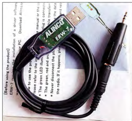
Bild 6: Bei Bedarf erleichtert ein optionaler Programmieradapter mit kostenloser Programmiersoftware die Verwaltung der mehr als 500 Speicherplätze und Einstellungen.
