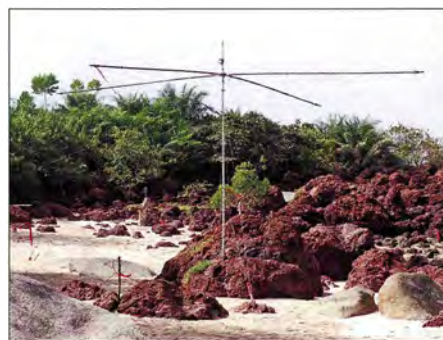
Einer der am Strand aufgebauten Spiderbeams
