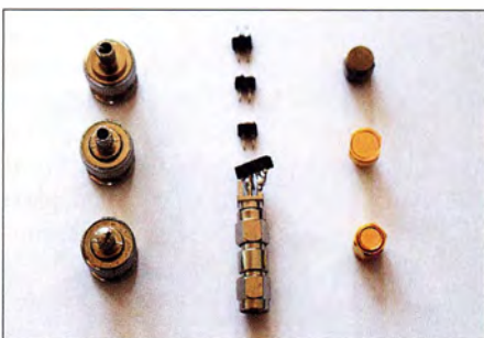
Bild 5: BNC-, Stecksocket- und SMA-SOL-Standards (v.l.n.r.) als Kalibrierelemente
