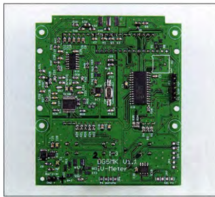
Bild 6: SMD-Bestückungsseite der Musterplatine des Antennenanalysators
