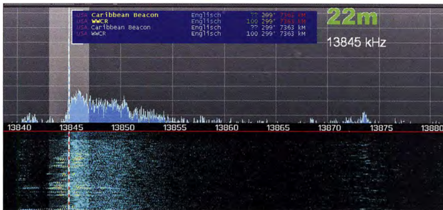
Bild 11: Identifikationshilfe: Das MWList-basierte Programm SenderINFO_sixpack überträgt Frequenzeinträge direkt in die Spektrumsanzeige. Screenshots: DJ6JZ
