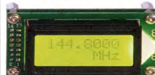
Über Taster programmierbarer Offsetbetrag: „-999,9999“... „0“... „+999,9999“ MHz
