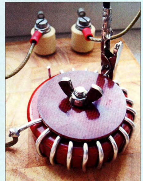
Bild 8: Abstimmspule des 80-m-Ringkern- spulen-Kopplers mit Abgriffmöglichkeit über eine Krokodilklemme (identisch mit der Ab- stimmspule des 160-m-Kopplers)
