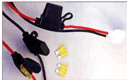
Bild 4: Drei 20-A-Flachsicherungen schützen Gerät und das insgesamt über 3 m lange Anschlusskabel.
