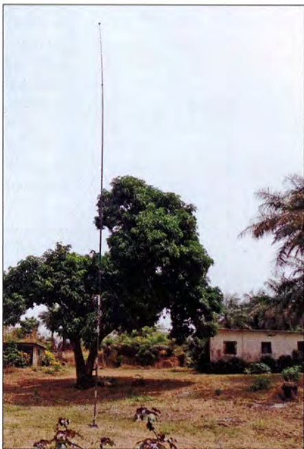
Unsere 18 m hohe 160-m-Vertikalantenne mit Dachkapazität
